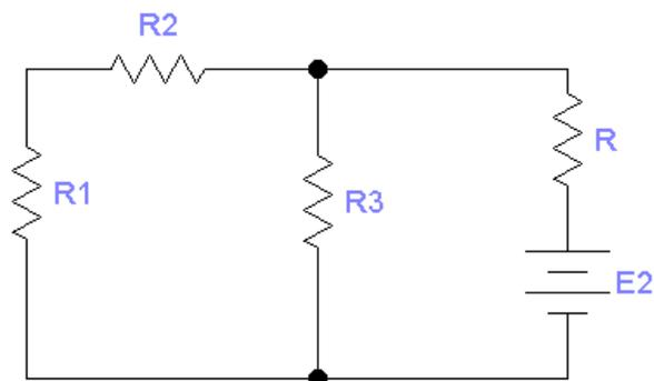
Figura 2. Porzione di circuito da semplificare mediante il teorema di Thevenin.
