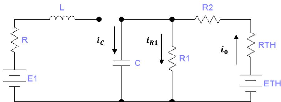
Figura 3. Circuito per la determinazione della tensione  $v_C(t)$
